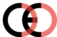
Marcatura CE contraffatta (troppo vicino)
